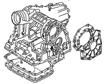
THE DESIGNATION CODE FOR THIS TRANSMISSION IS NOT FOUND ON THE UNIT, IT CAN BE FOUND IN DRIVER SIDE DOOR JAM UNDER TRANS TYPE.
